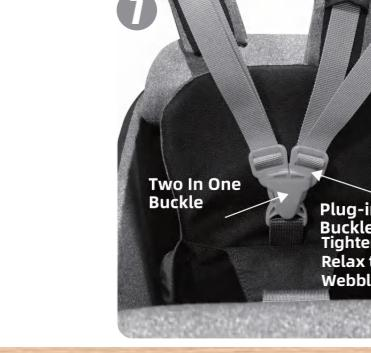
**儿童座椅高度调整完成后，调整儿童肩带的松紧度（图 ①）。肩带的松紧度是通过座垫前端一只二插扣件进行调节的。扣件上有两只插件。调节插件上的织带以达到儿童肩带松紧度调节。**
